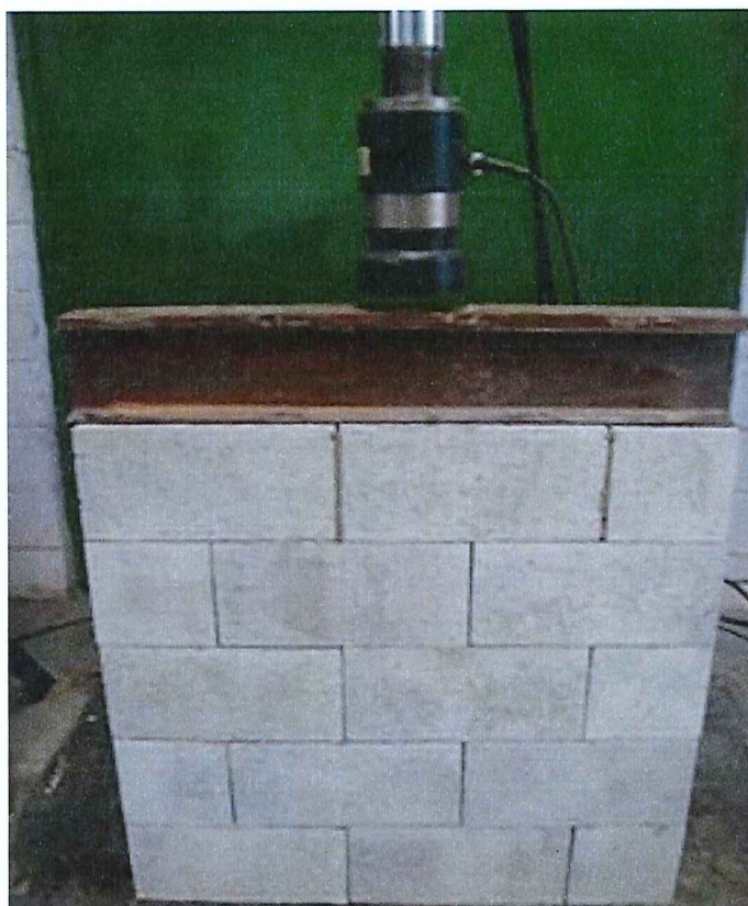
Foto n.º 01 – Visualização do ensaio de resistência à compressão de pequenas paredes
