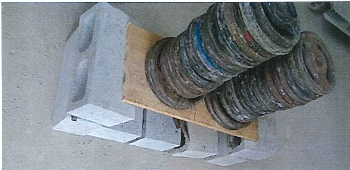
Foto n.º 02 – Visualização da ocorrência no ensaio de flexão
