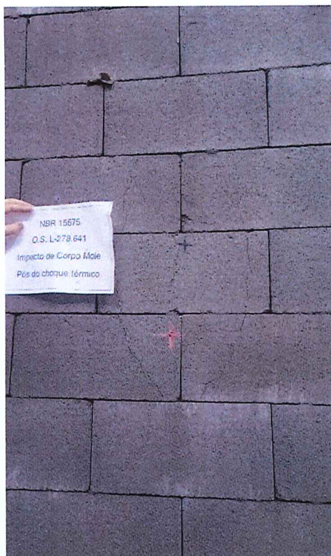
Foto n.º 06 – Visualização da ocorrência no ensaio de impacto de corpo mole após choque térmico
