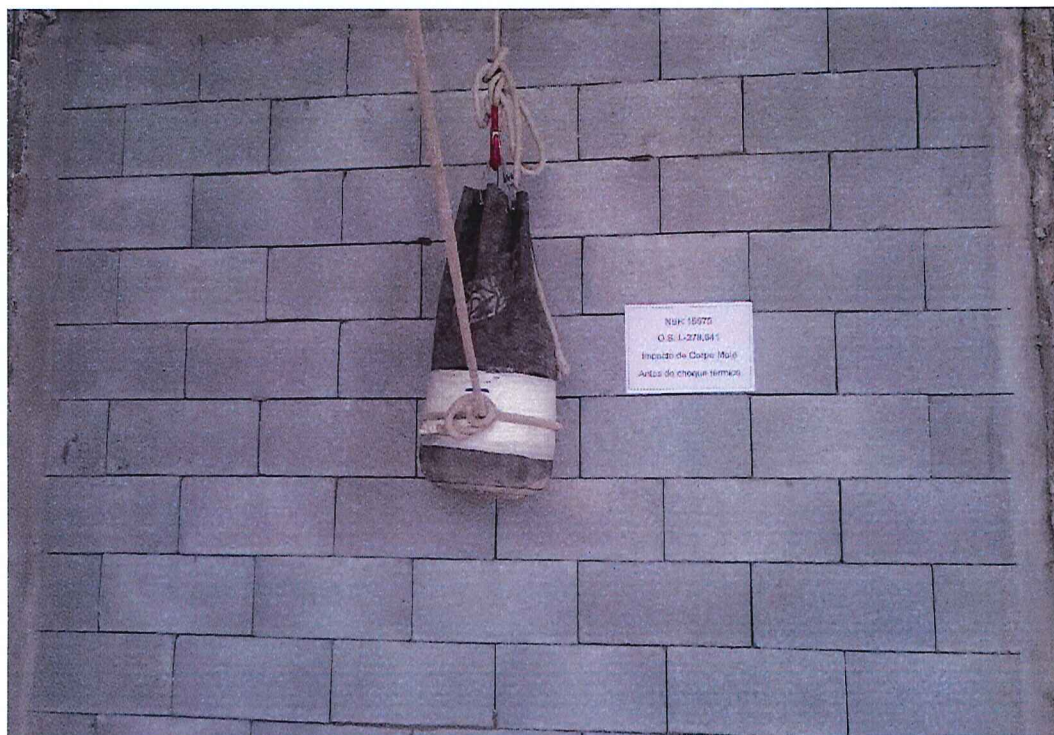
Foto n.º 03 – Visualização do ensaio de resistência ao impacto de corpo mole antes do choque térmico
