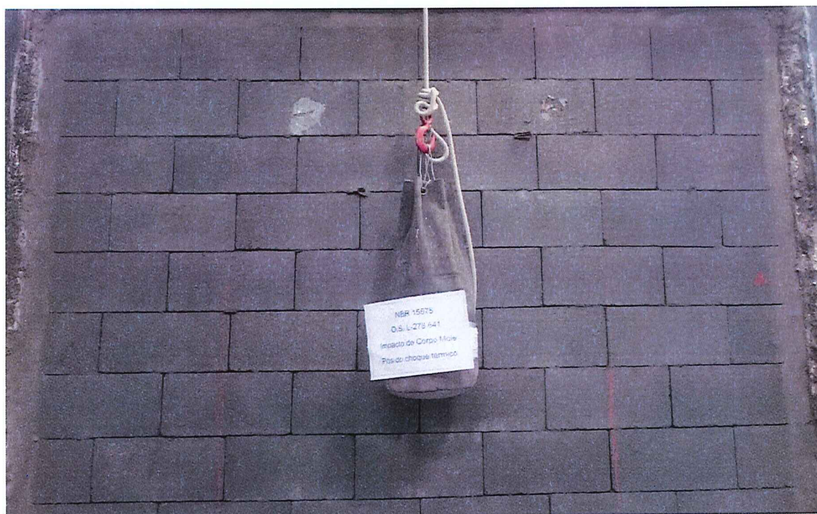
Foto n.º 05 - Visualização do ensaio de resistência ao impacto de corpo mole após choque térmico
