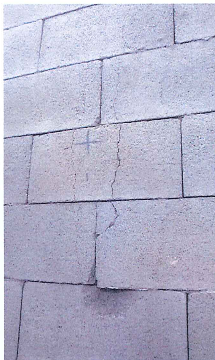
Foto n.º 07 – Visualização da ocorrência no ensaio de impacto de corpo mole após choque térmico
