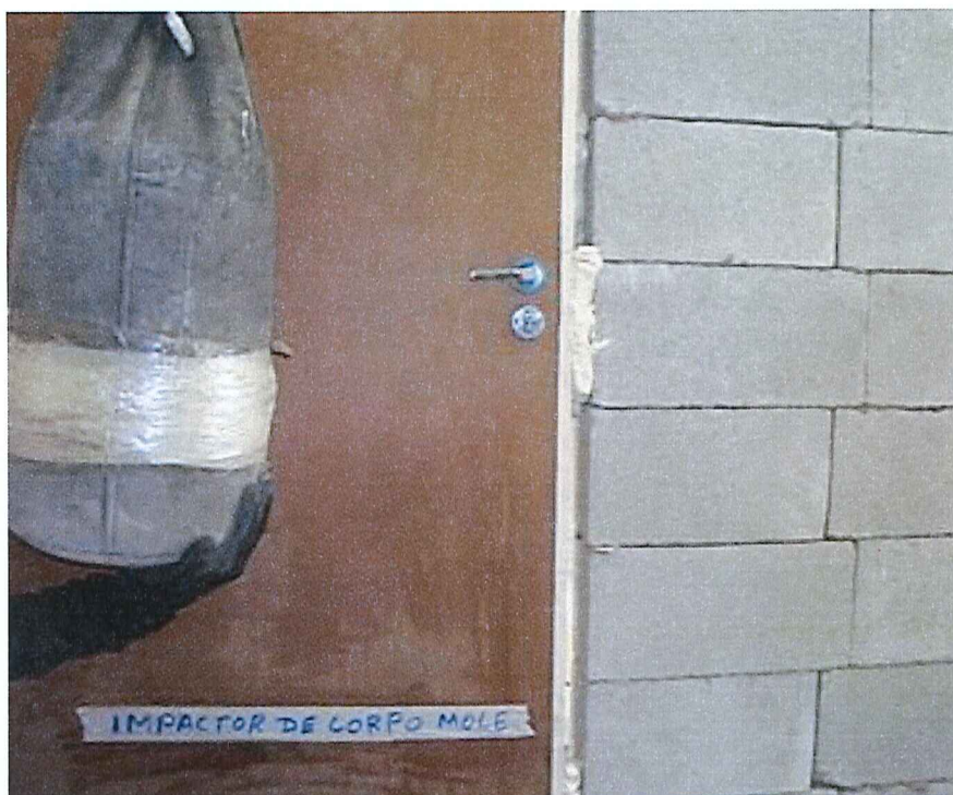
Foto n.º 08 – Visualização do ensaio de resistência ao impacto de corpo mole em porta de madeira
